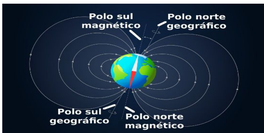
Figura 11 - Desenho esquemático indicando os polos geográficos e magnéticos da Terra.
