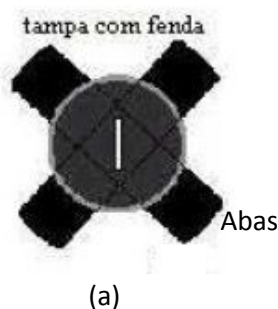
Figura 10 – (a) Ilustração de como fazer a tampa com a fenda. (b) Imagem fotográfica do espectroscópio caseiro (b) lado da abertura com o cd, e (c) o lado da fenda.
